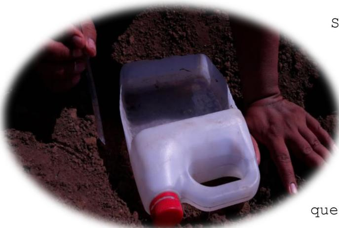
Se hace un hoyo en la superficie del suelo y se coloca la pana tipo sopera o galón, de manera que el borde del recipiente quede al ras de la superficie de suelo colocando tierra alrededor del recipiente para que se una totalmente con el
