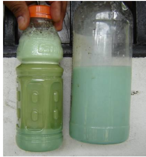
Figura 6. Envase con y sin sedimento en prueba de calidad de mezcla de plaguicidas
